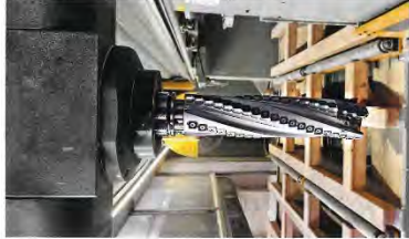
Der Casor-Bohr- und Universalfräser ist mit einer Stahlkrone versehen (oben). Somit sind auch die härten Buchendübel im Reinholz (unten) bei der Bearbeitung kein Problem.
